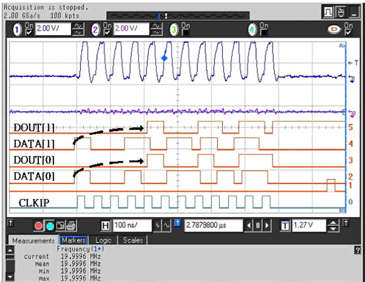
圖 4.4 移位暫存器在 PIXEL_DATA 狀態下的傳遞狀況
