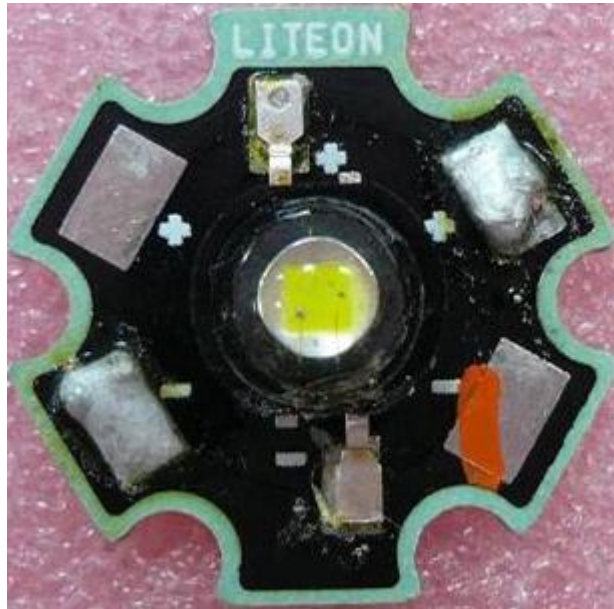
圖 4-1 Sapphire-based LED 封裝完成圖
