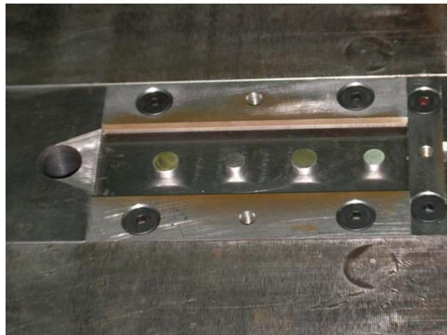
圖 4.9 壓力感測器之實際配置
