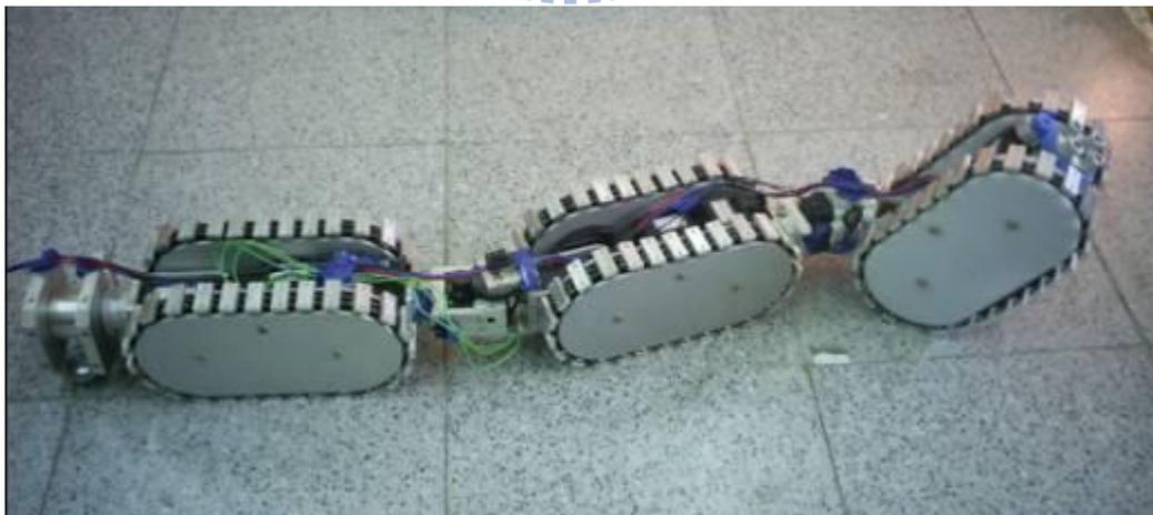
圖 2-3 串結式機器人實體圖
