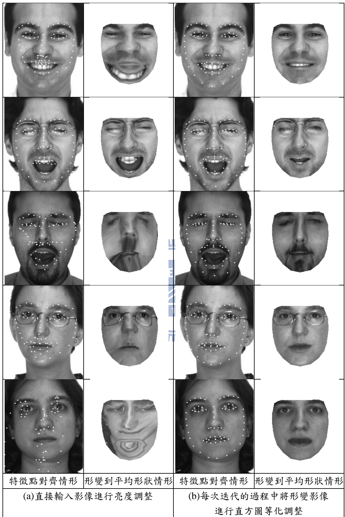
圖 2-29、在每次迭代的過程中將形變影像進行直方圖等化調整與直接對輸入影像
