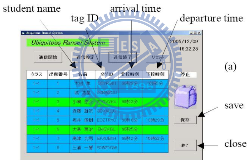
圖 1.6 以 RFID 來實現網路伺服器小孩上下學安全控管介面[4]
