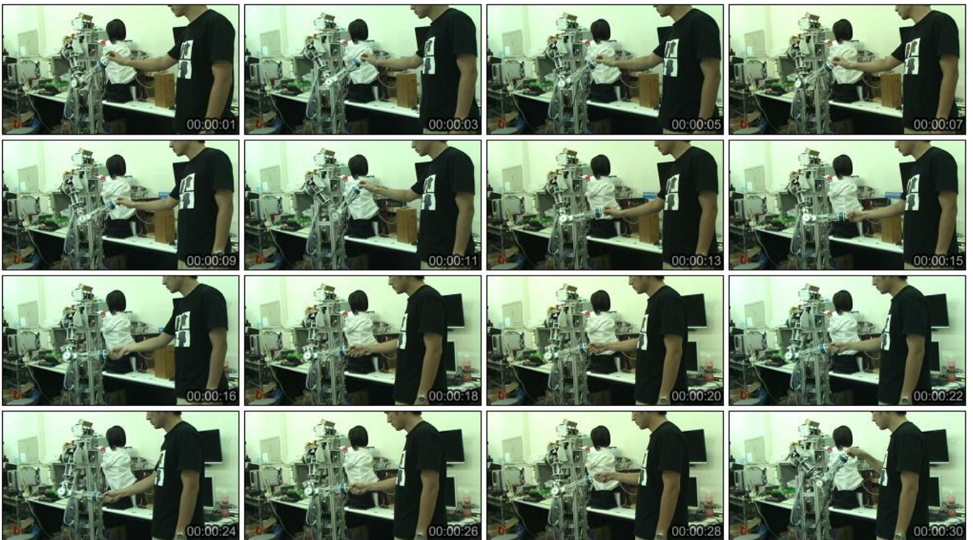
圖 6.2 機械手臂順應外力過程
