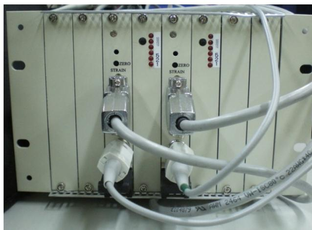
圖 3.18 兩軸力感應器訊號擷取卡
