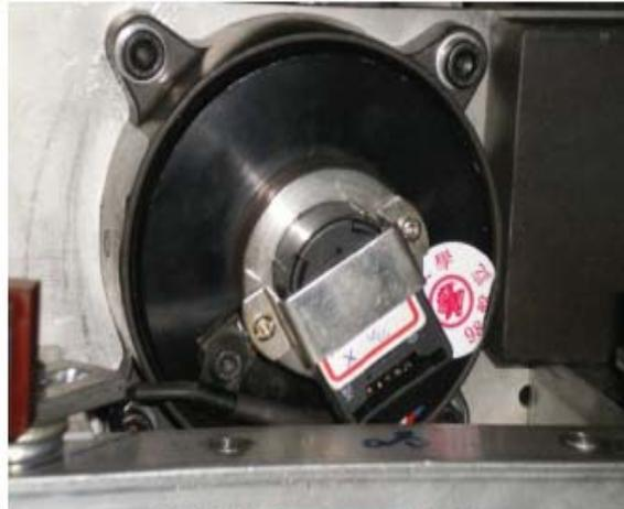
(b)軸編碼器加裝於伺服煞車器
