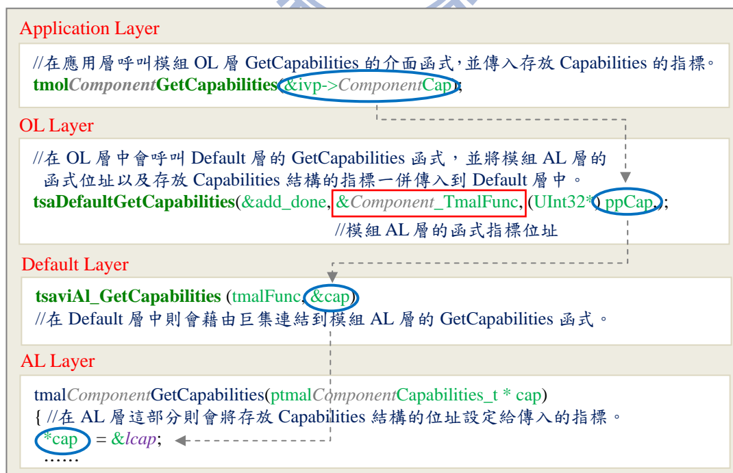
圖 2.6 設定 Capabilities 的函式流程
