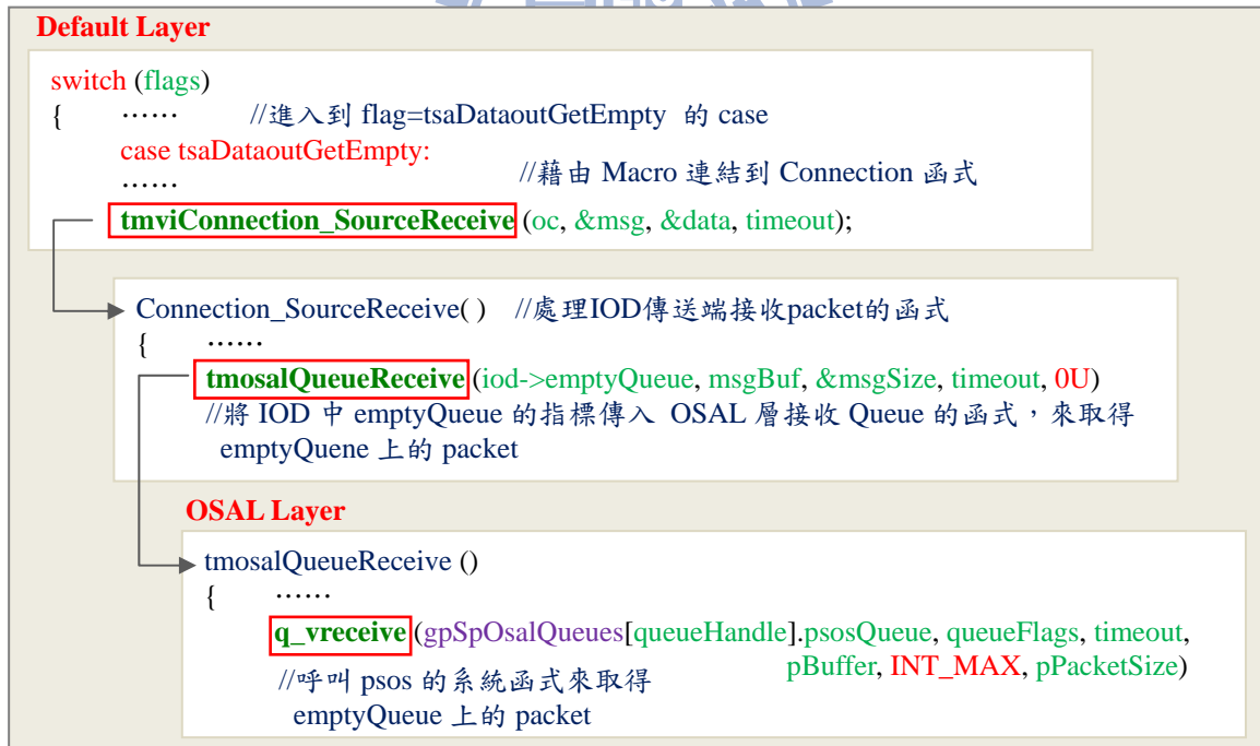
圖 3.10 拿取空 packet 的函式流程
