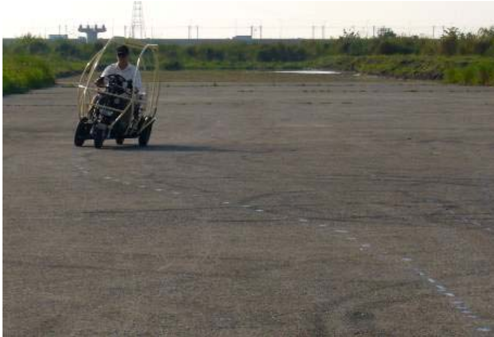
圖 22 具傾斜動作之曲行測試
