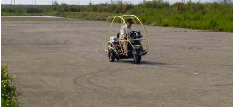
圖 21 不具傾斜動作之曲行測試
