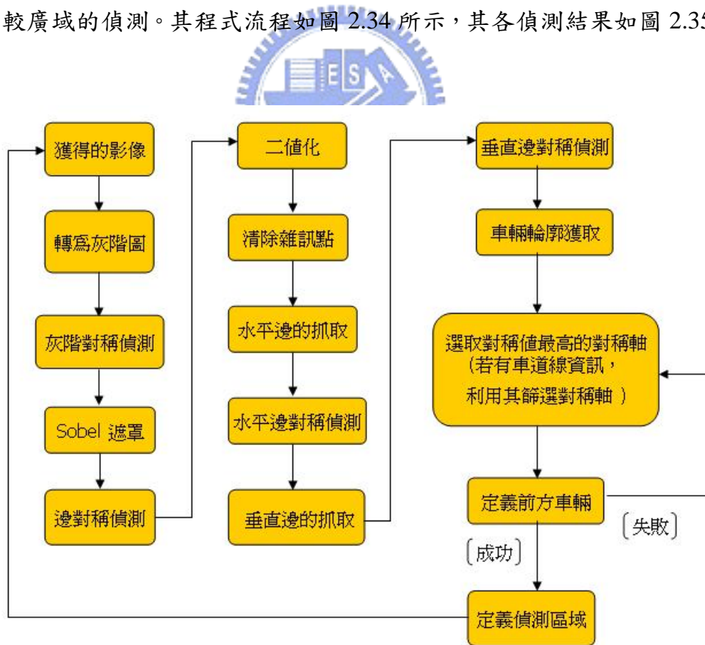
圖 2.34 以對稱特性偵測前方車輛之方法其程式流程
