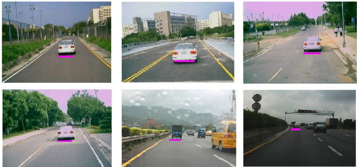
圖 2.35 以對稱特性偵測前方車輛之方法其偵測結果
