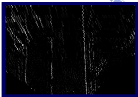
圖 2.5 利用灰階特徵所擷取出的車道線
