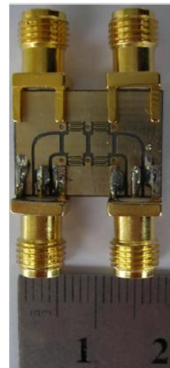
圖 3-7 縮小化舷側耦合方向耦合器
