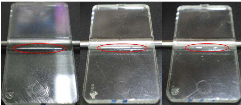
圖 4- 21 PC 原試片熱循環 6 次後開裂 (case1 & case2 & case3)
