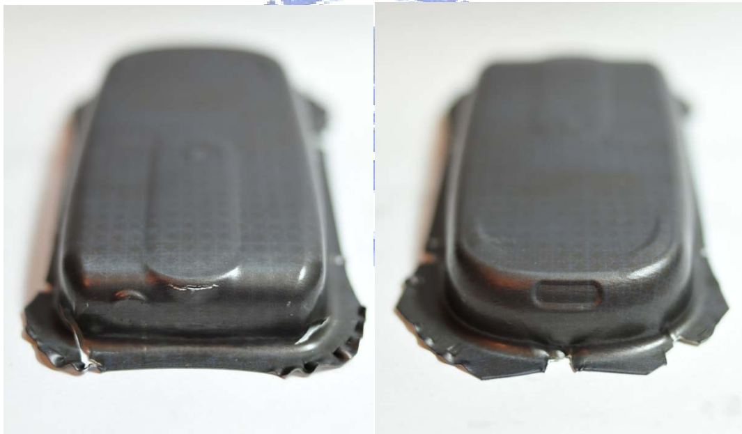
圖A.9 Ti/Al板材板液壓成形實驗結果 (1 ton)
