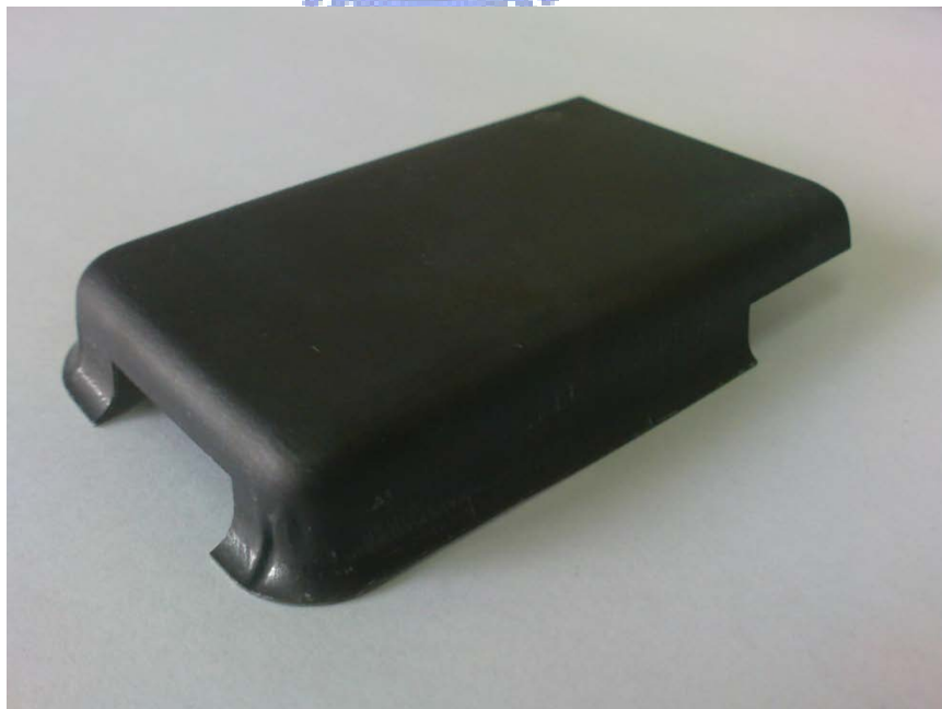
圖5.1 手機背蓋之板液壓成形成品
