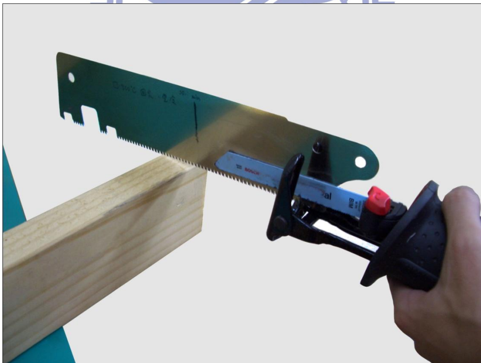
圖 3-19 磨耗試驗鋸片與松木位置
