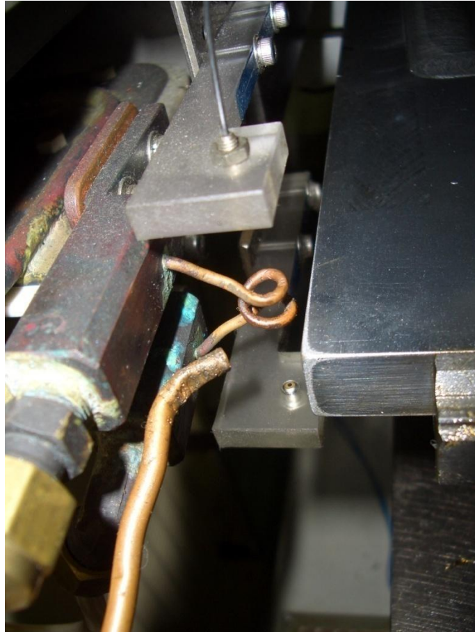
圖 2-7 感應加熱線圈、空氣吹嘴與鋸齒位置感應器
