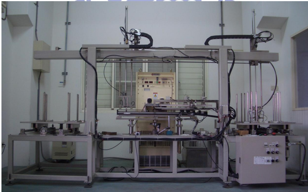
圖 3-9 感應熱處理機與自動運輸裝置總成
