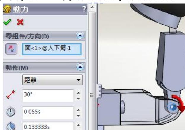
圖 4. 68 投籃動作四的動力設定 2
