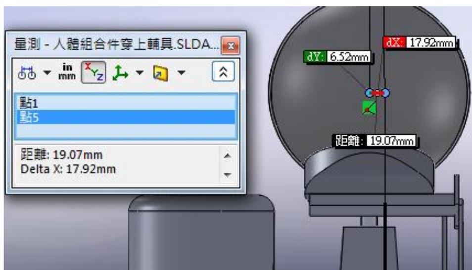
圖 4. 88 量測裝上輔具投籃模擬結果的球心偏移距離
