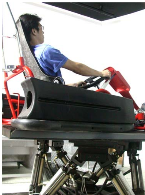
圖1-2、虛擬實境車輛駕駛模擬系統實際照片
