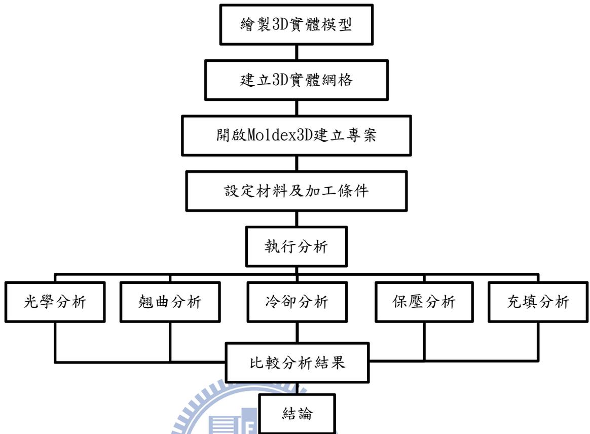
圖 3.2 Moldex3D 模擬分析流程圖
