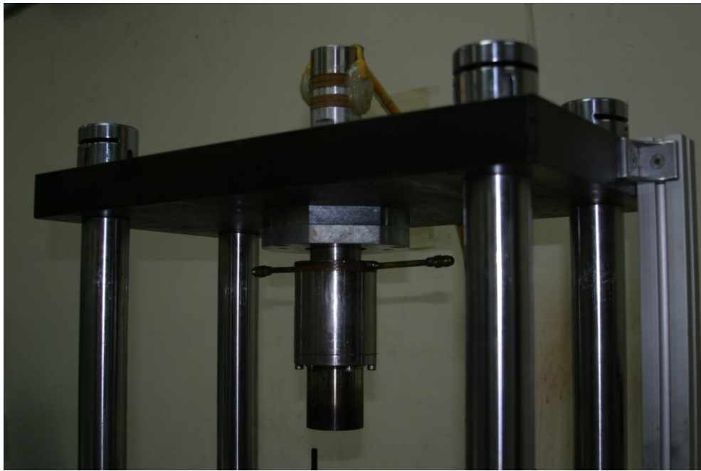
圖 2-18 超音波系統與熱壓機台之組合
