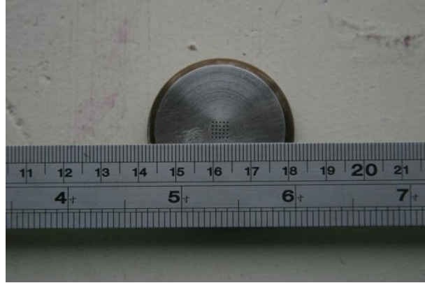
圖 3-40 放電球形陣列模仁外觀(尺標單位 mm)
