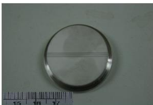
圖 3-37 放電加工 V 溝結構模仁(尺標單位 mm)
