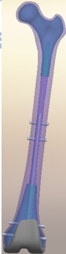
圖 2-17、人工膝關節置換後植入骨髓內釘模型
