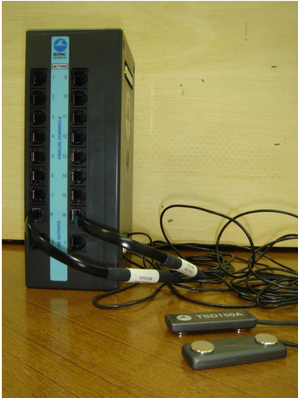
圖 12 表面肌電訊號量測裝置
