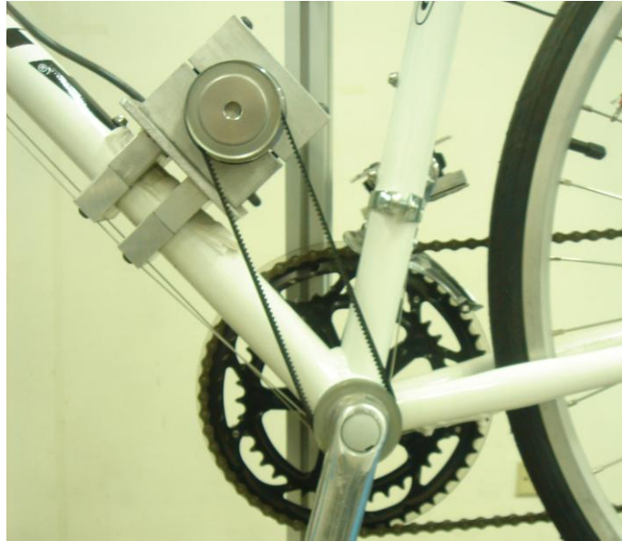
圖 8 編碼器夾具與同動機構
