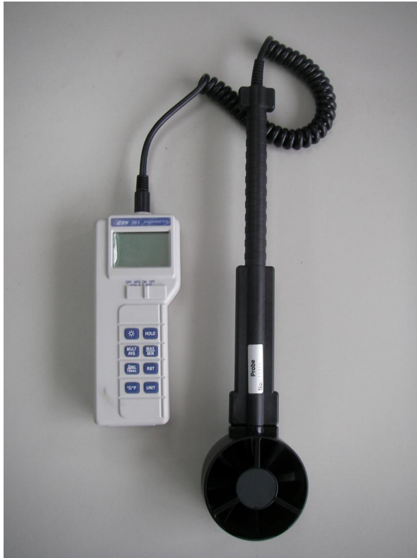
圖 14 風速計與風速探棒
