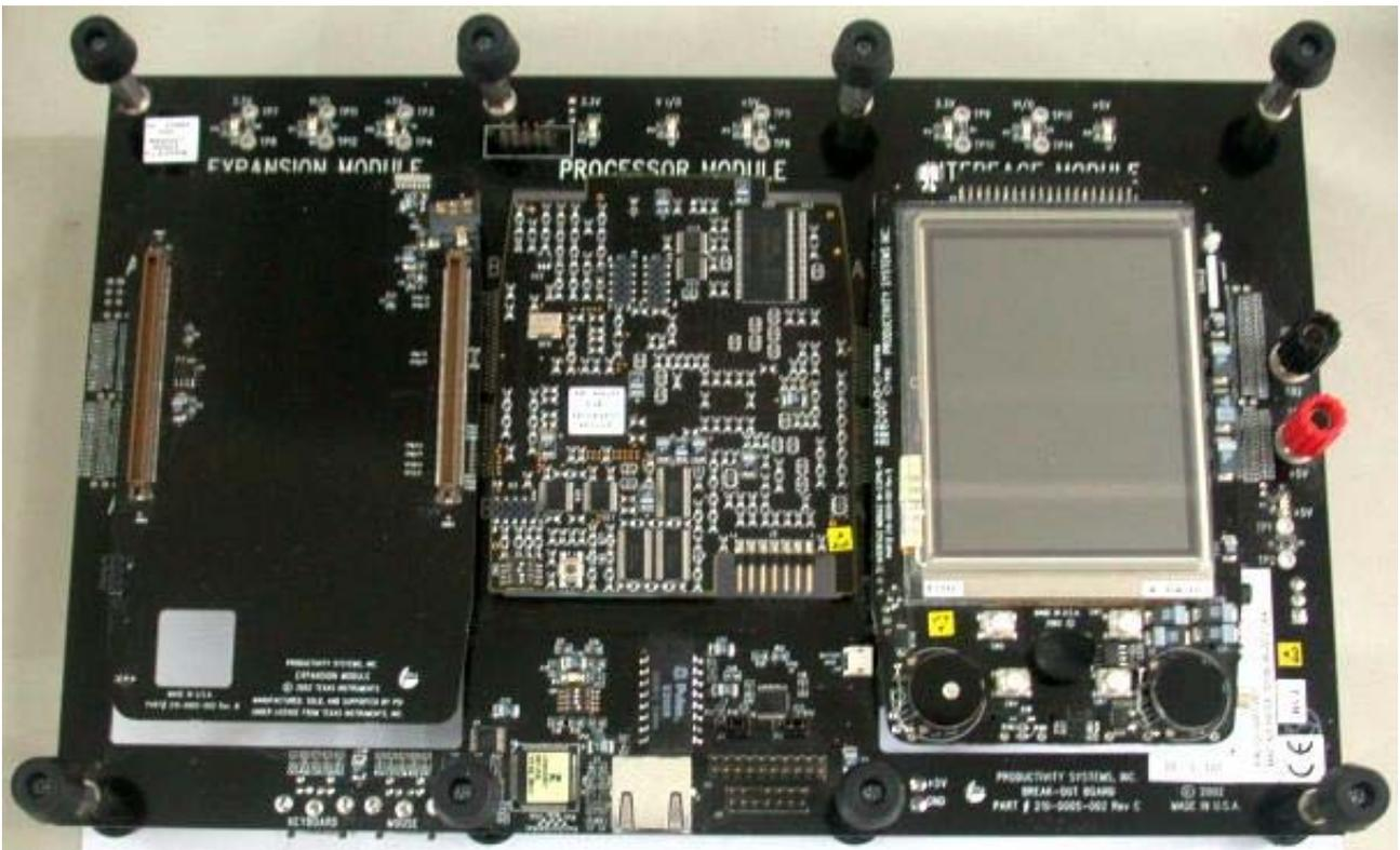
圖 A-4 Innovator Development Kit 的 Break Out Board 配件模組
