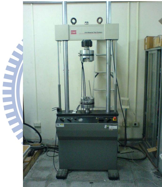
圖 2.1 MTS-810 拉伸試驗機
