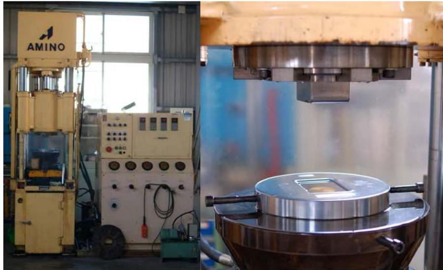
圖 4.1 板液壓成形機台
