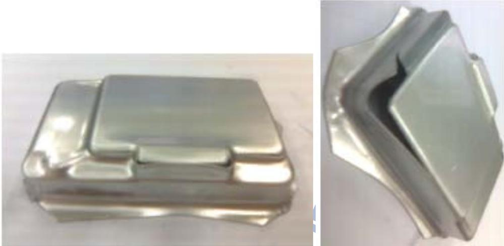
圖 4.47 初始板件形狀成形結果
