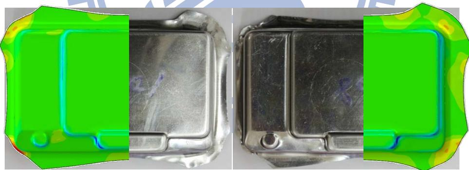
圖 4.10 A1050 之殼件實驗與模擬變形情形比較
