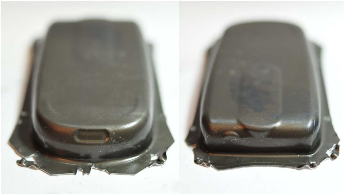
圖 1.11 鈦鋁複合板成形後殼件無破裂[6,7]
