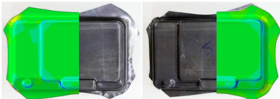
圖 4.11 鈦鋁複合板材之殼件實驗與模擬變形情形比較
