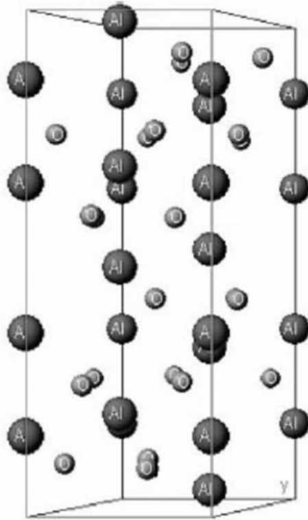
圖 2-3 藍寶石晶體之六方最密堆積結構圖 [5]
