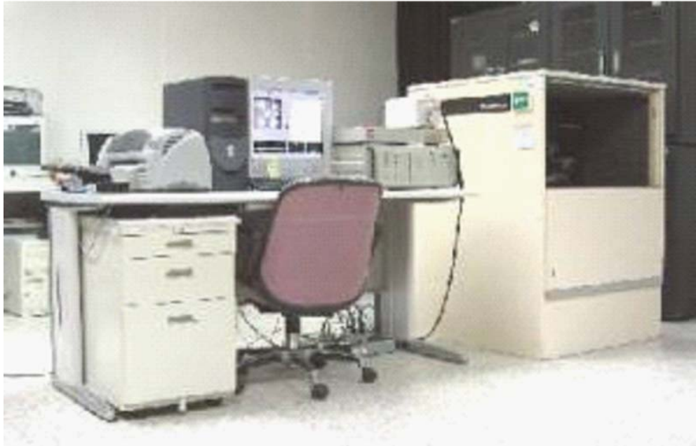
圖 3-4 奈米壓痕量測系統 [50]
