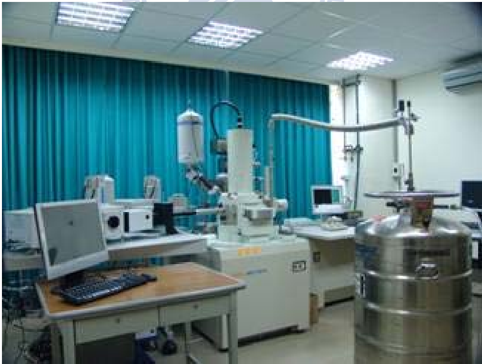
圖 3-7 低溫陰極螢光系統 [51]
