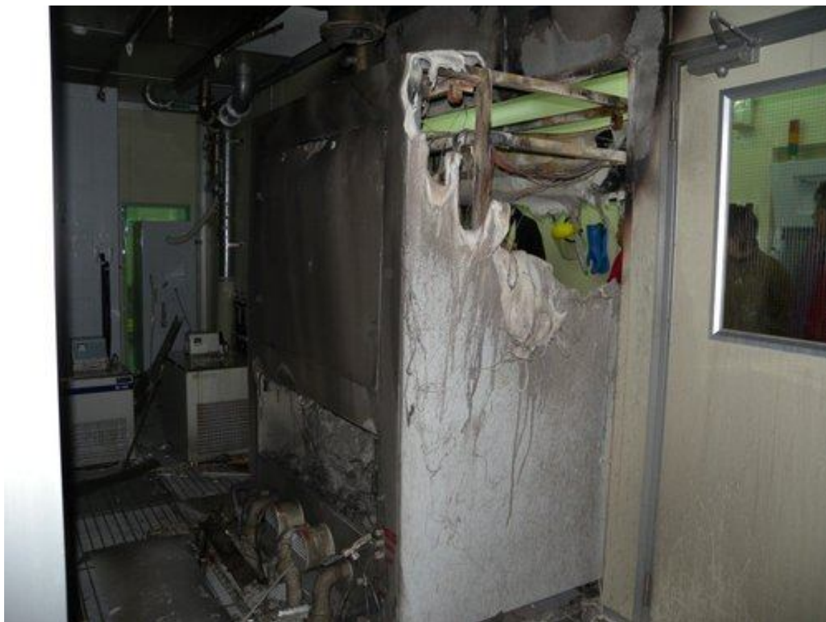
圖 1-8 MEMS 微機電系統廠無塵室濕式晶圓清洗機起火[19]
