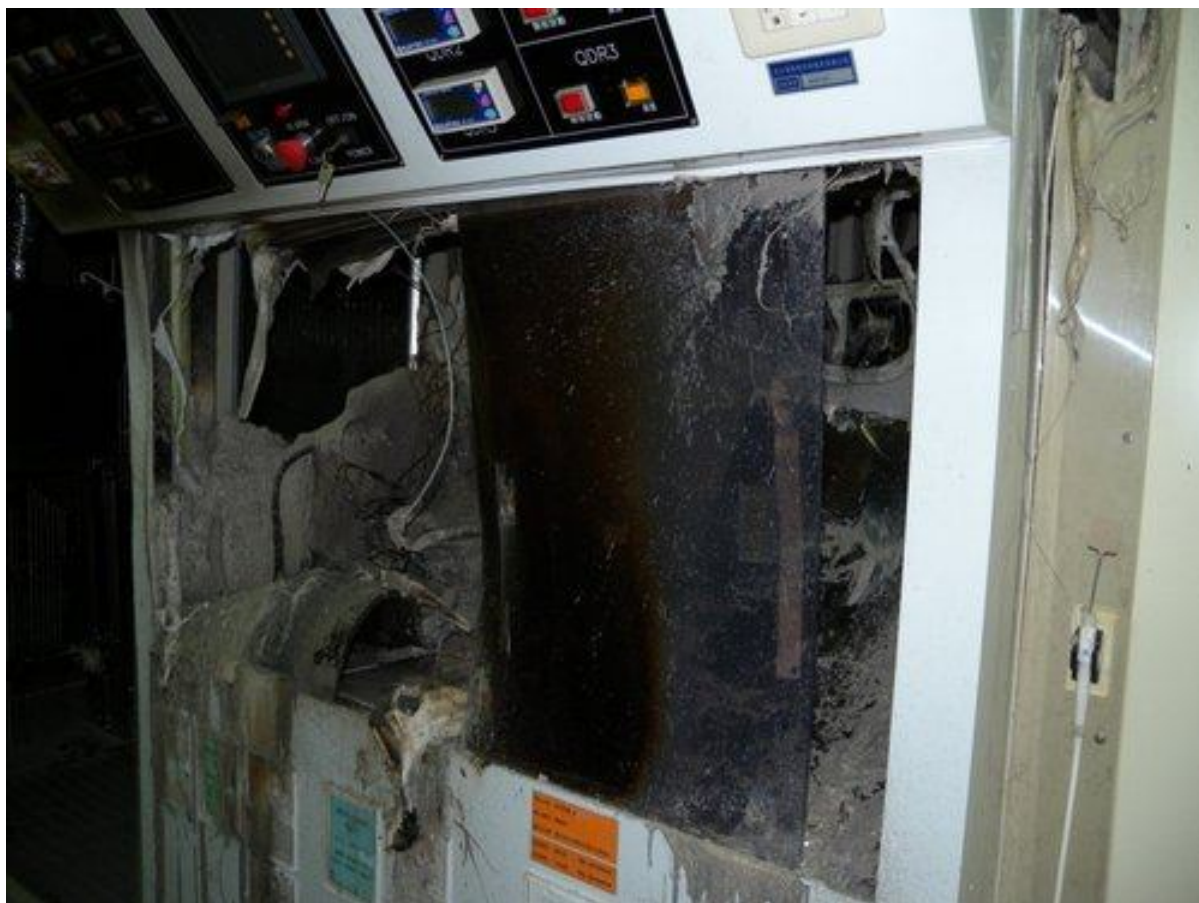
圖 1-6 MEMS 微機電系統廠無塵室濕式晶圓清洗機起火[19]
