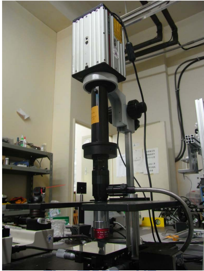
圖 5-3 顯微實驗平台及高速攝影機
