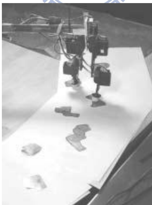
圖 1-4 使用機器視覺辨識路面狀況的二足機器人 [6]
