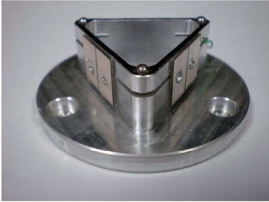
圖 4.6 超音波馬達定子結構三原型，接觸點為鋼球
