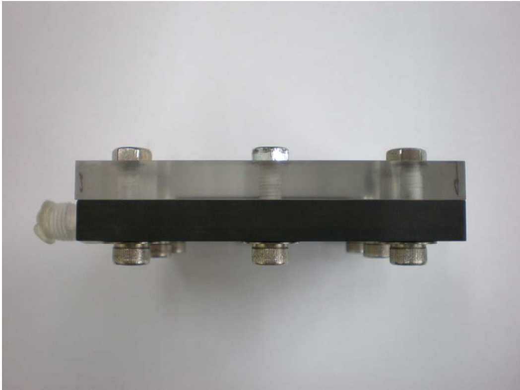
圖 3.2.3 石墨複材流道板試片組裝完成照片
