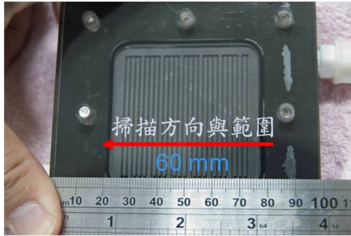
圖 3.2.5 石墨流道板試片線掃描方向與範圍
