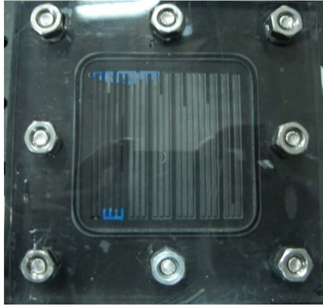
圖 3.2.9 組裝完成部分含水之石墨複材流道板
