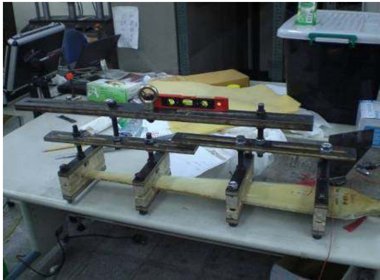
圖 37. Whiffle tree 實體組裝
