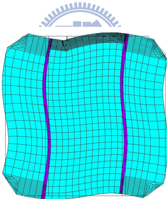
圖 3.29 含裂縫太陽能電池矽基板面內共振頻率 35.68kHz 對應之振形
