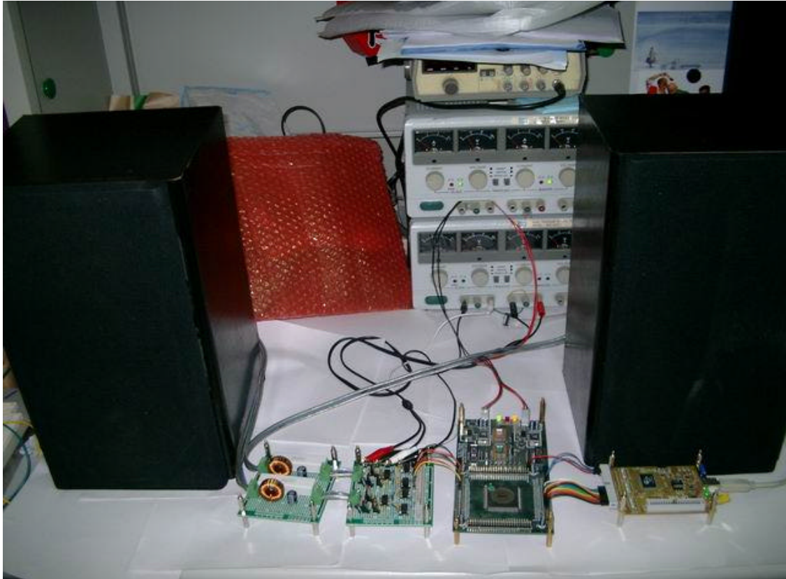
圖 6.1 具 USB 介面之雙聲道全數位式音頻放大器
