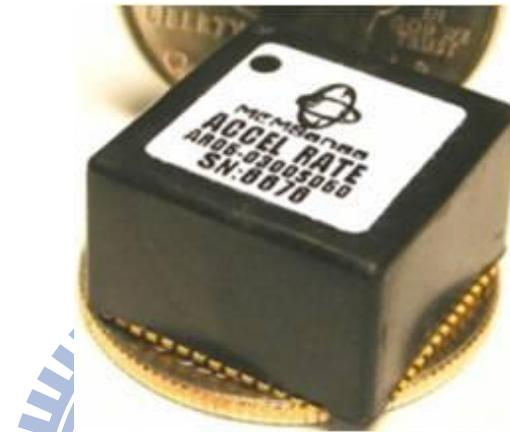
圖(3.1)IMU 元件
