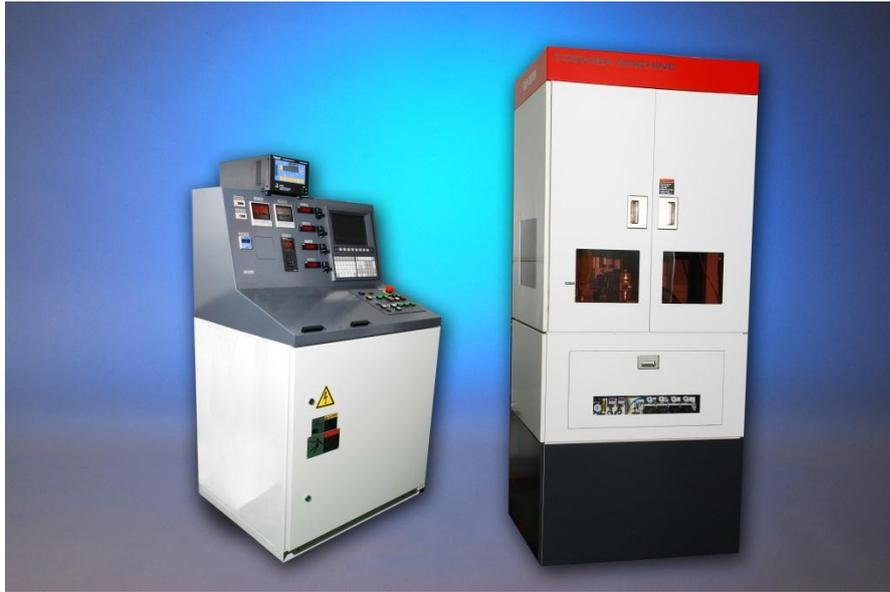
圖 26 高溫玻璃模造機
