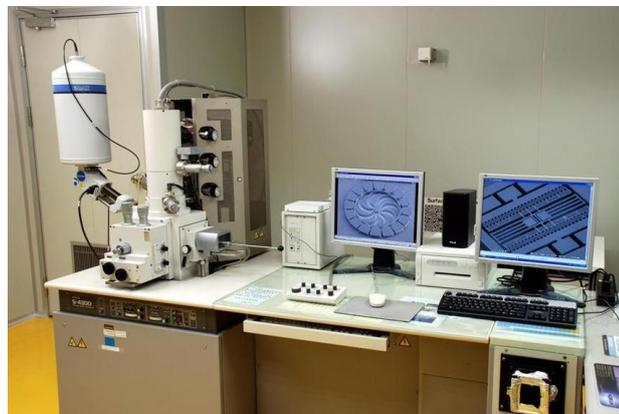
圖 42 冷場式掃描電子顯微鏡(SEM)
