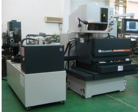
圖 39 線切割放電加工機
