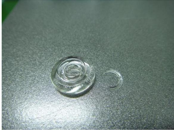
圖 153 微結構破裂
