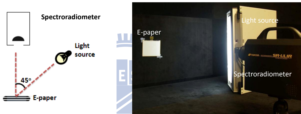
[圖 5-1] 量測實驗平台：(a)幾何量測示意圖；(b)實際架設圖
