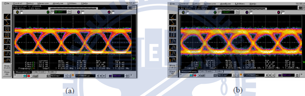
圖 3-5 藍光 10Mb/s 在(a)15cm(b)30cm 的距離下傳輸的眼圖[14]
