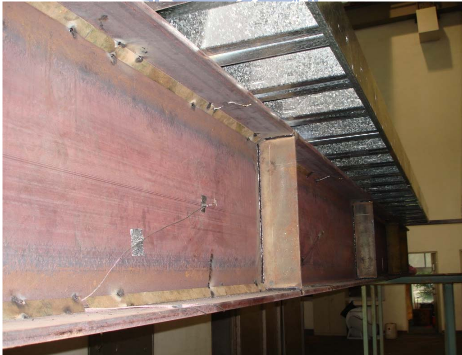
圖 3-4 鋼梁腹板熱電偶線設置
