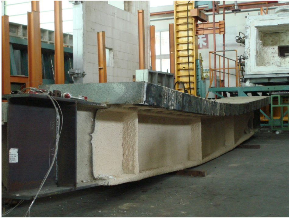
圖 3-50 試體 2 試驗後試體之永久變形
