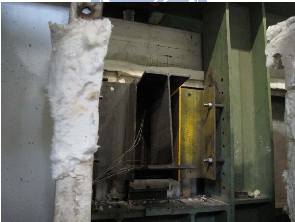
圖 3-53 試體 3 支撐端扭轉情況
