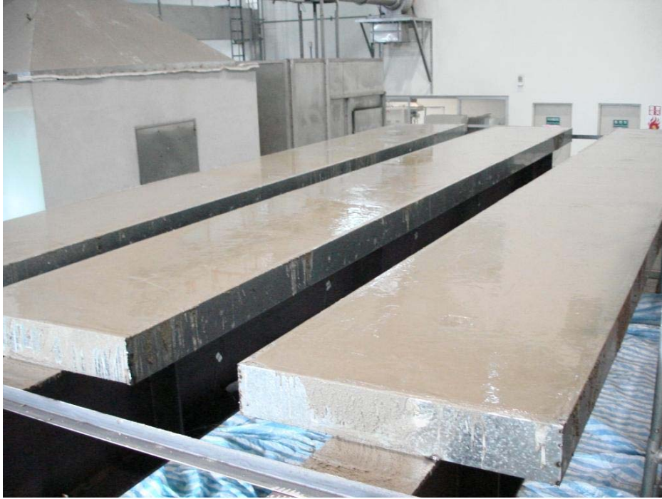
圖 3-3 試體樓板混凝土施工完成
