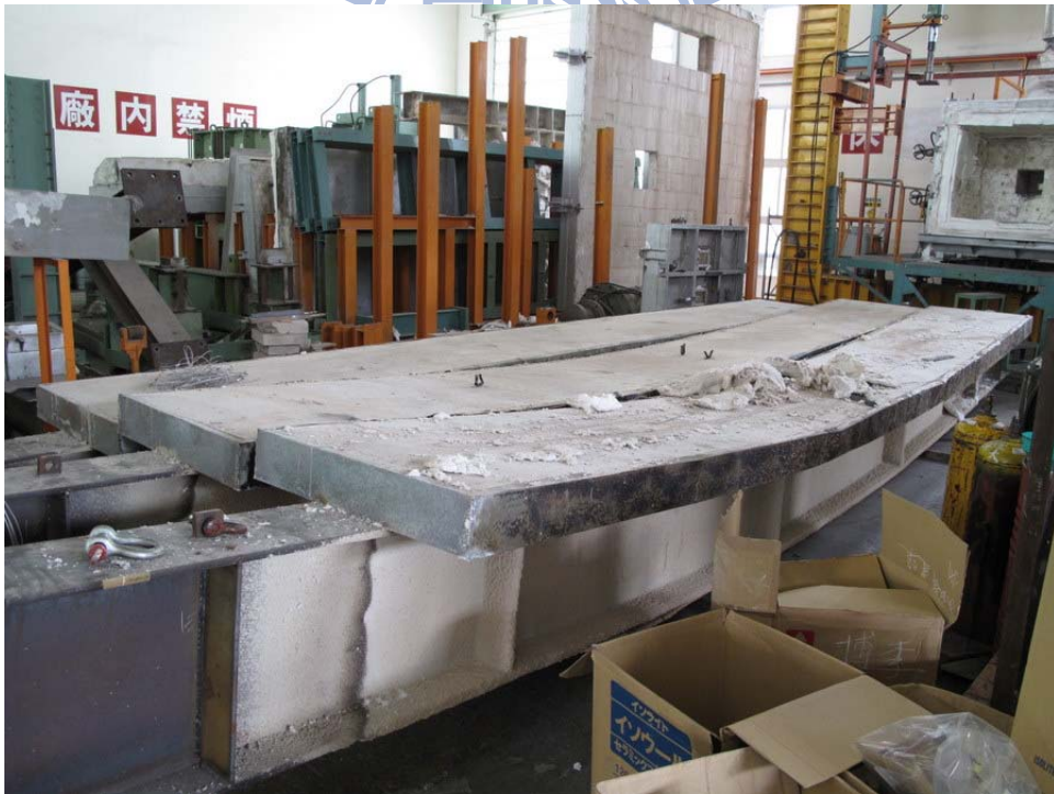
圖 3-59 三組試體試驗結束後永久變形情形
