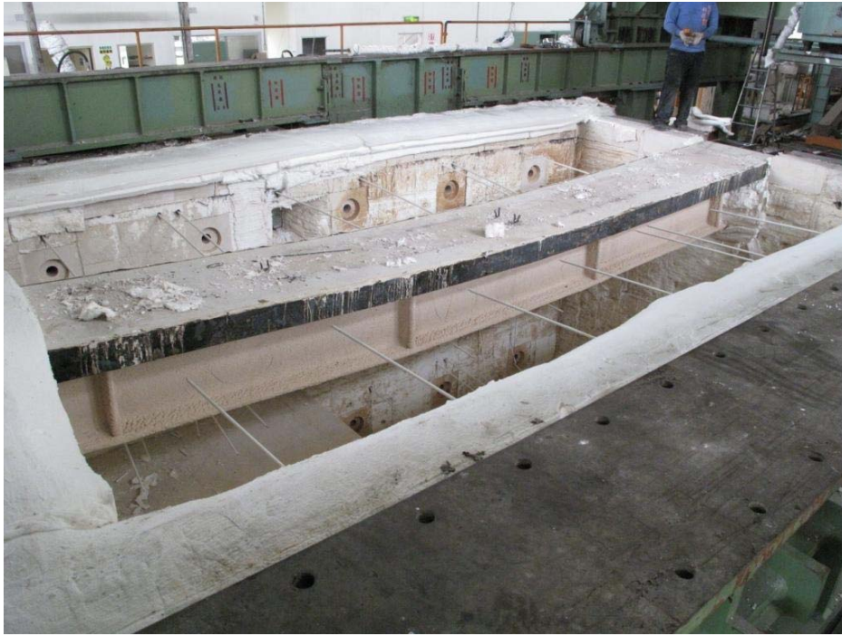
圖 3-48 試體 2 試驗後試體在爐內情況
