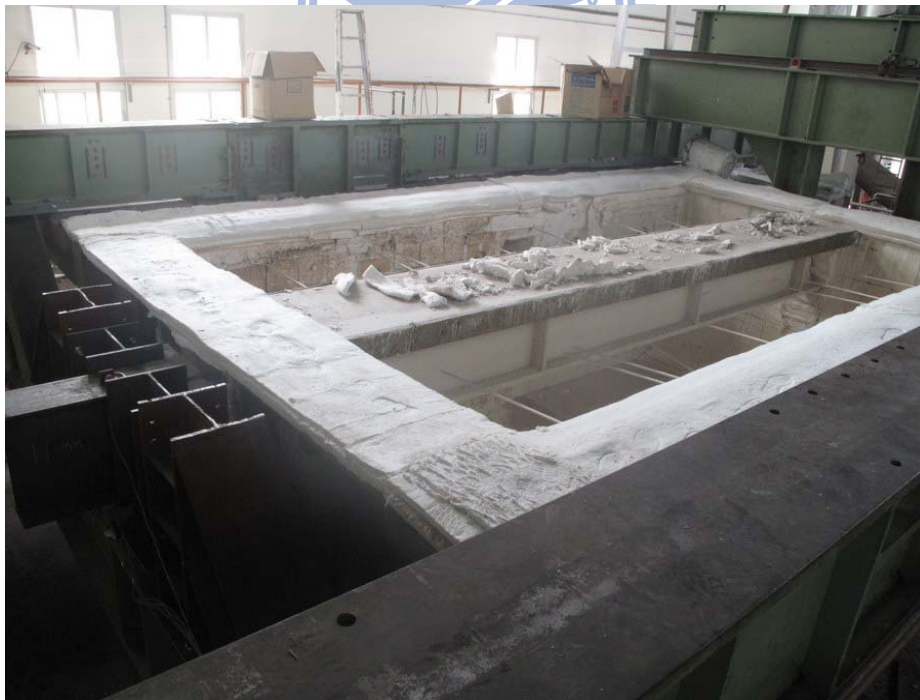
圖 3-44 試體 1 試驗後試體在爐內情況
