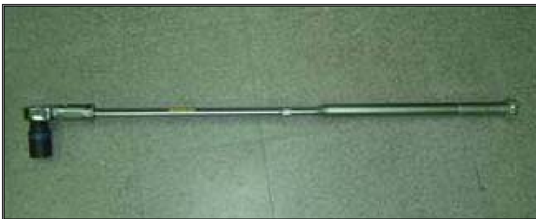
圖 2.6 大型扭力扳手(扭力範圍:80~560 N-m)
