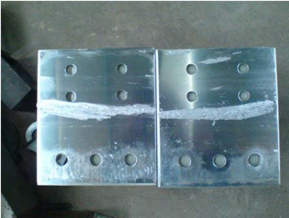
圖 3.33 合金鋁試驗後局部產生刮痕
