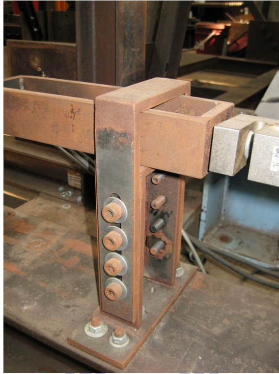
圖 3.25 測試支座組裝完成照片
