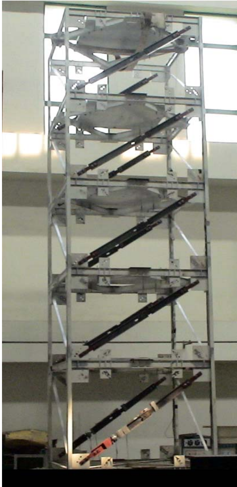
圖 1.15 摩擦阻尼斜撐之耐震性能試驗照片【13】
