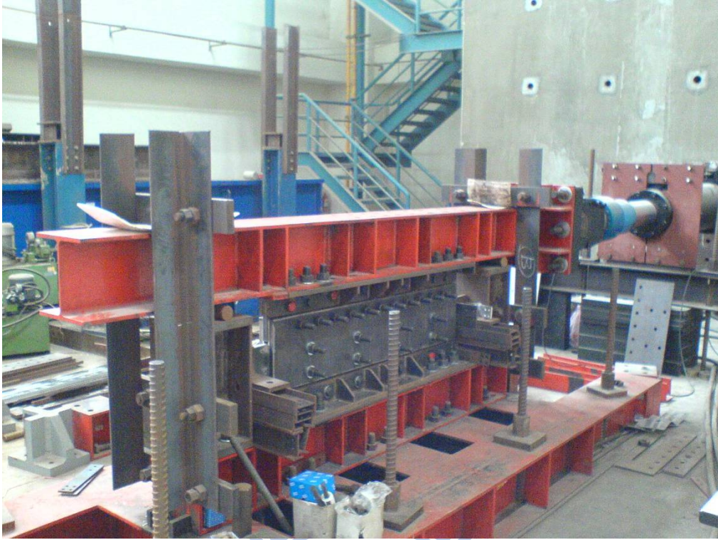
圖 3.7 實尺摩擦阻尼元件測試組裝完成照片
