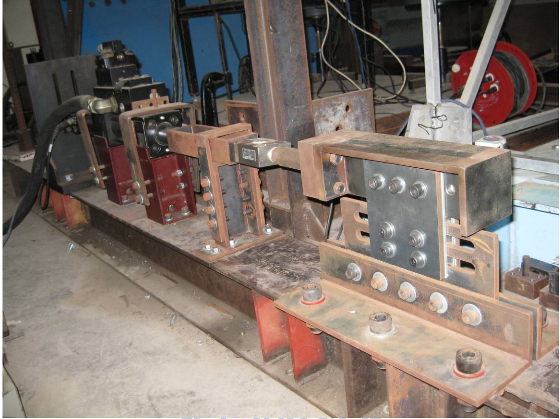
圖 3.22 縮尺摩擦阻尼元件測試安裝完成照片
