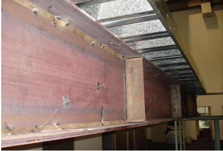
圖 4-4 鋼梁熱電偶線設置 (趙文成與陳誠直 2009)
