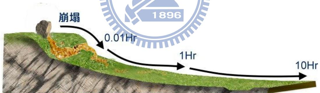
圖 3-1 單點崩塌示意圖
