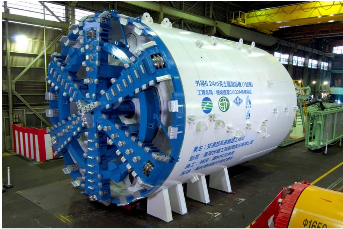
圖 4-6 桃園國際機場捷運 CU02A 標潛盾隧道施工採用之泥土壓潛盾機(1 號機)
