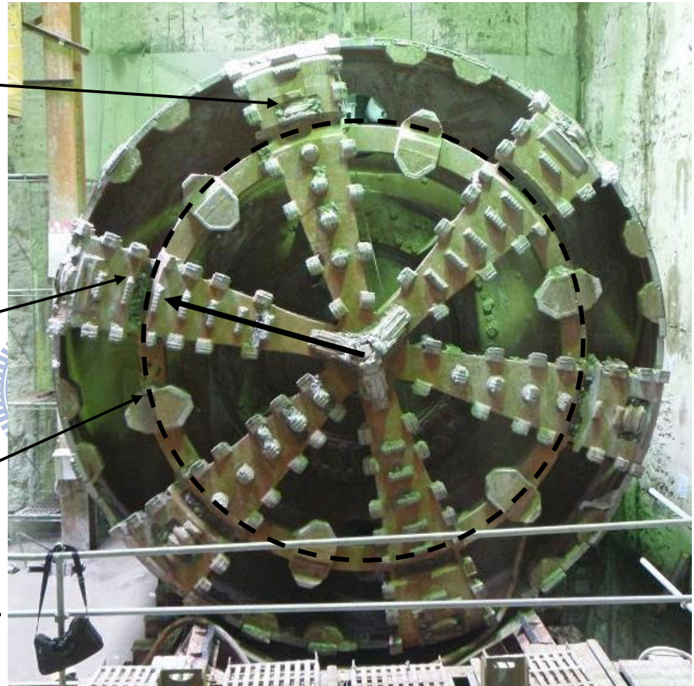
圖 4-12 1 號潛盾機出土時切刀轉盤磨損情形
