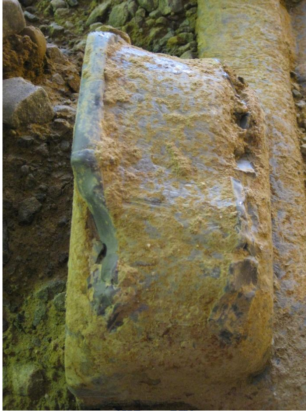
(a) 切刀轉盤上固定切刀之磨損
