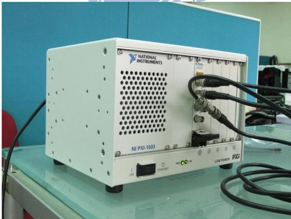
圖 3.5 訊號擷取卡及波形產生器
