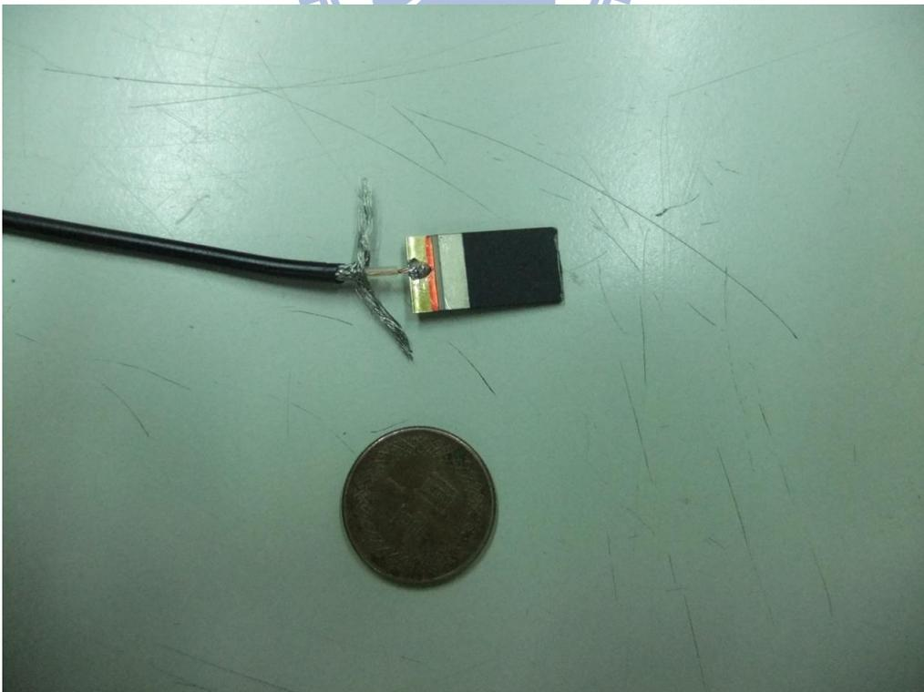
圖 3.12 同軸線中心銅線銲接於壓電片中層金屬片
