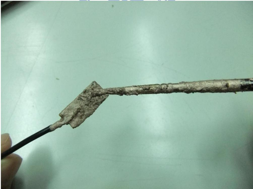
圖 3.14 導電漆於壓電片之塗製
