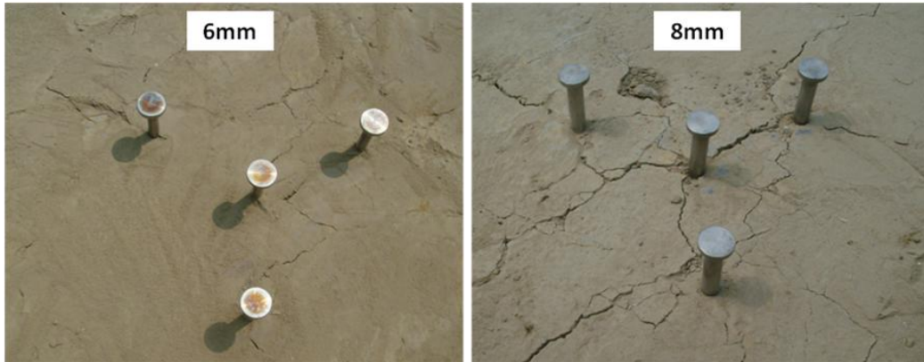
圖 4-33 不同尺寸鋼釘在現地試驗情況
