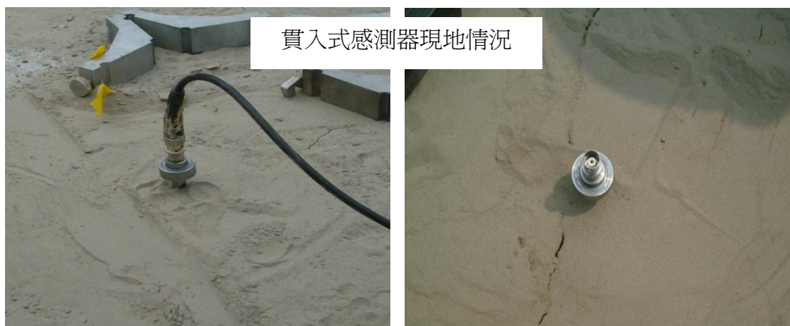
圖 4-35 貫入式感測器現地試驗情況
