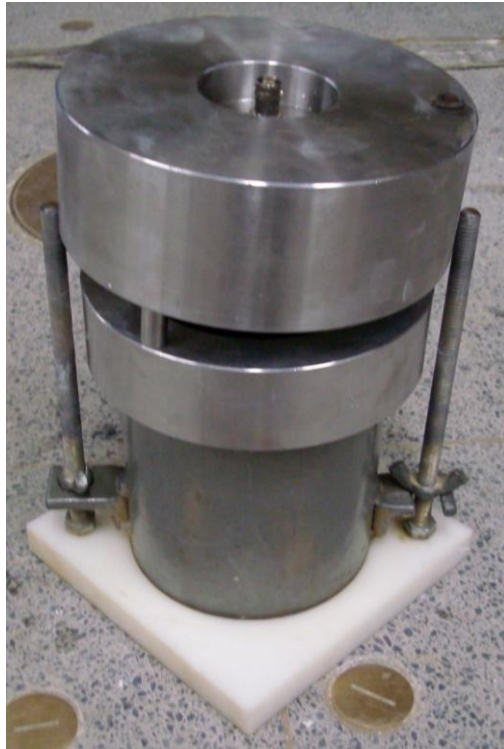
圖 2-12 介電度量測試驗用之 TDR 同軸感測器
