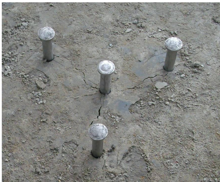
圖 4-16 現地釘子貫入土後之情形
