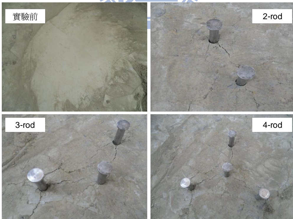
圖 4-27 現地 TDR 量測誤差來源探討-貫入擾動影響試驗情形
