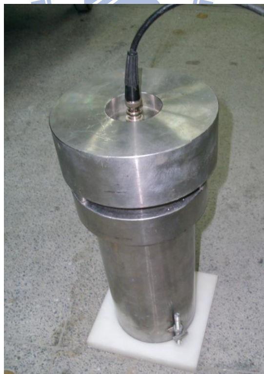
圖 3- 13 現地實驗同軸感測器
