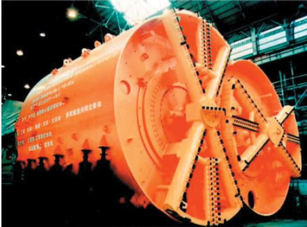
圖 3-1 東京都有明北地區供給管共同管道建設工程使用之大直徑 DOT 潛盾機
