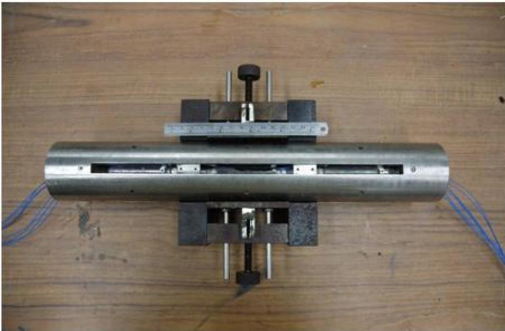
圖 3.14 傍壓儀簧片標定試驗圖
