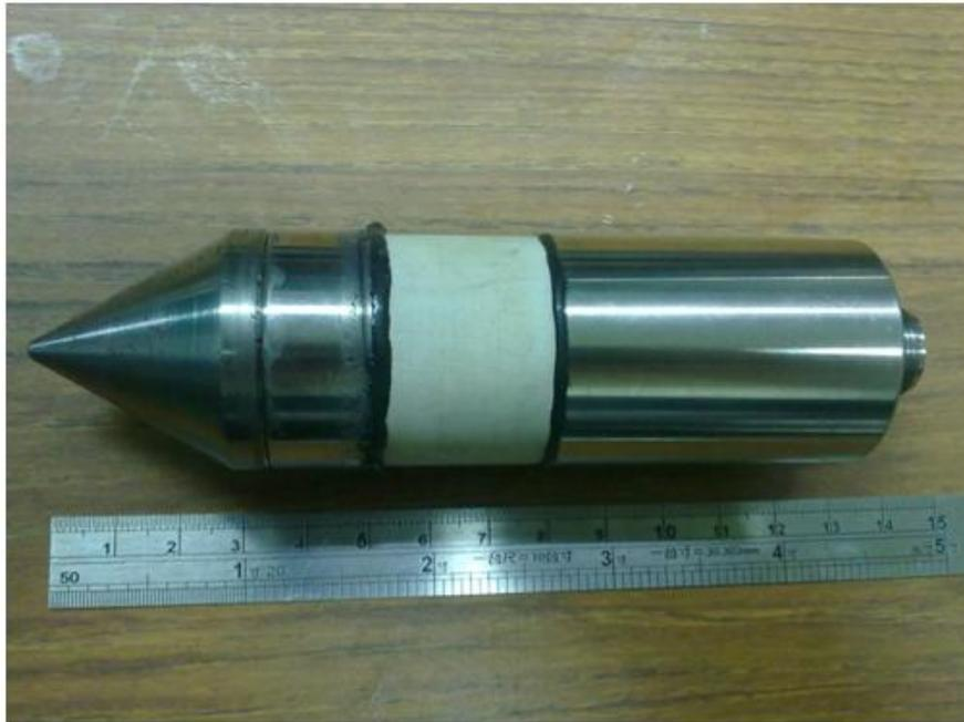
圖 3.7 椎狀貫入式張力計示意圖(摘自古景宇, 2011)
