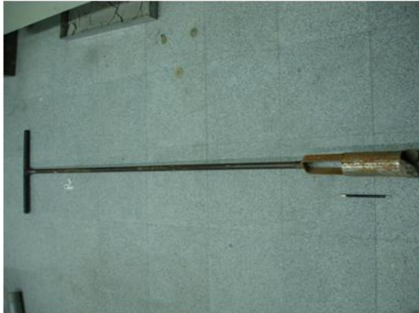
圖 4.10 手動鑽掘工具
