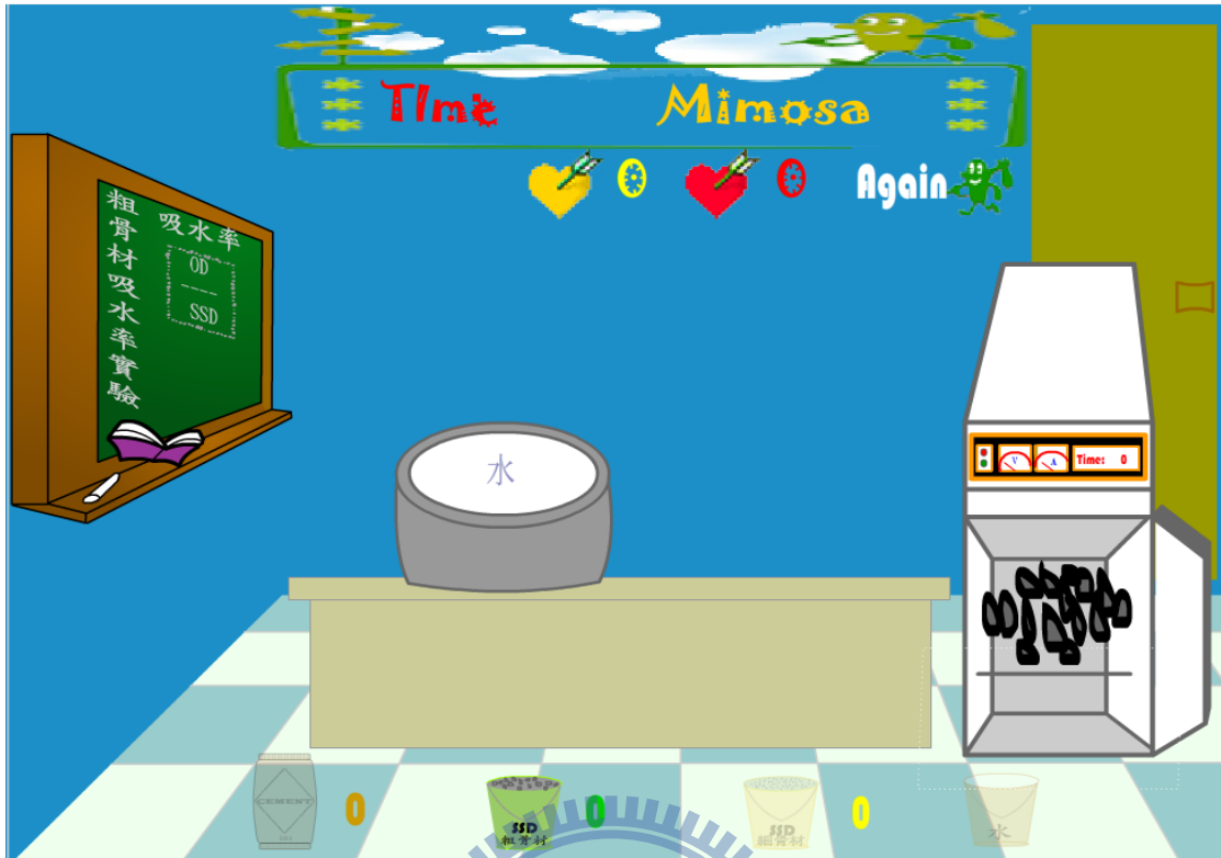
圖 3-42 粗骨材吸水率實驗—將粗石置入烘箱畫面
