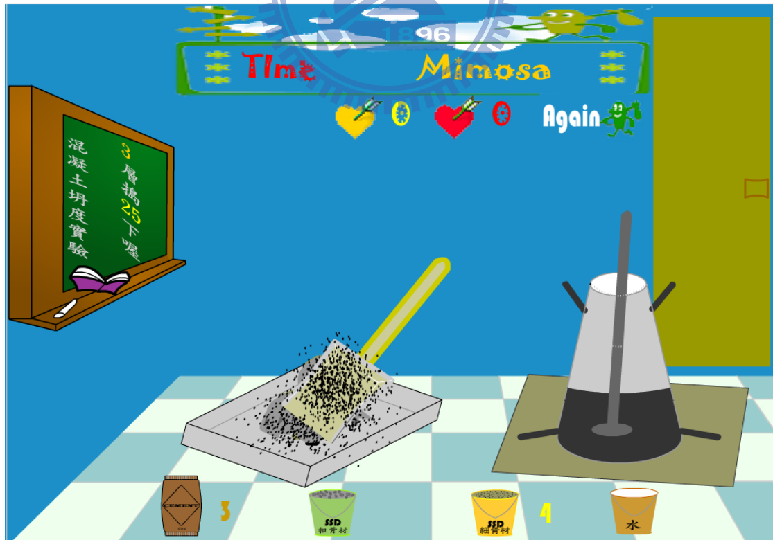
圖 3-65 混凝土坍度實驗—填入第一層畫面
