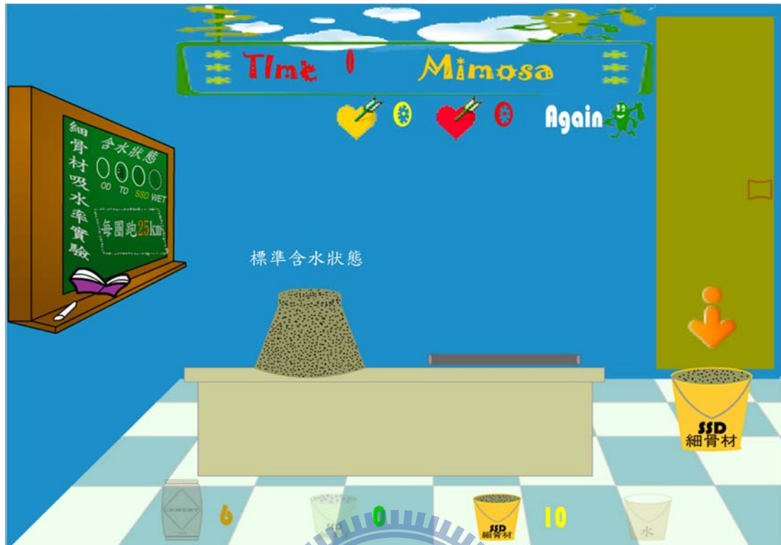
圖 3-30 細骨材吸水率實驗—完成砂錐體畫面(一)
