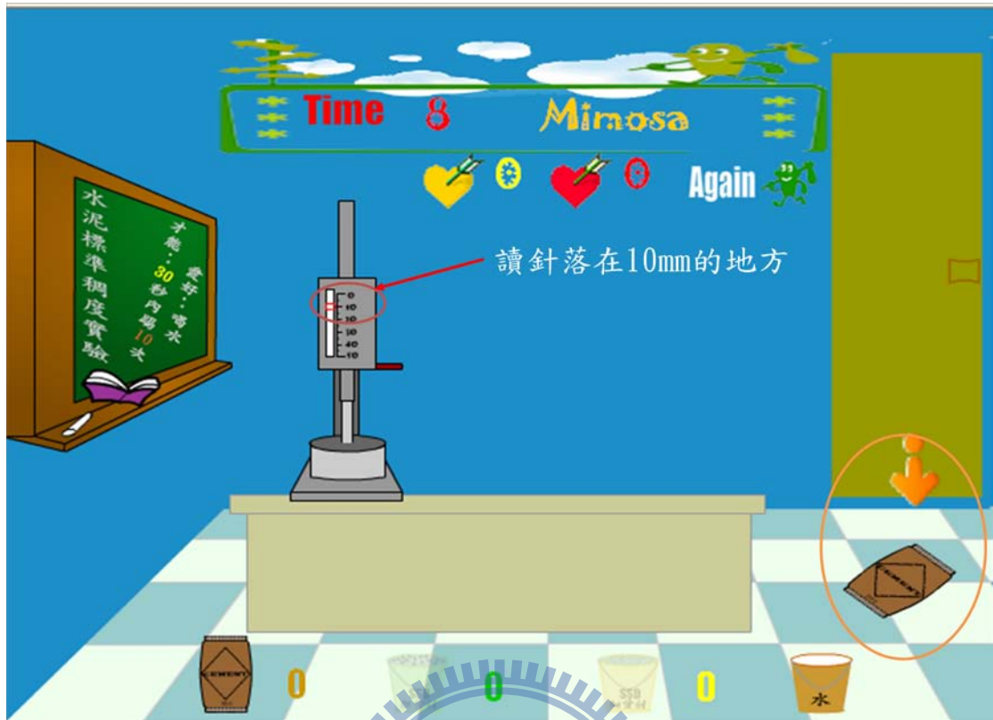
圖 3-24 水泥標準稠度實驗—維卡儀讀針動作畫面
