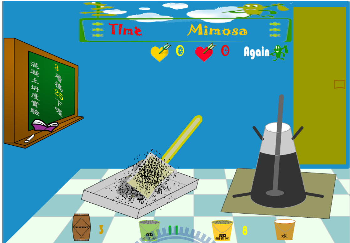
圖 3-66 混凝土坍度實驗—填入第二層搗實畫面
