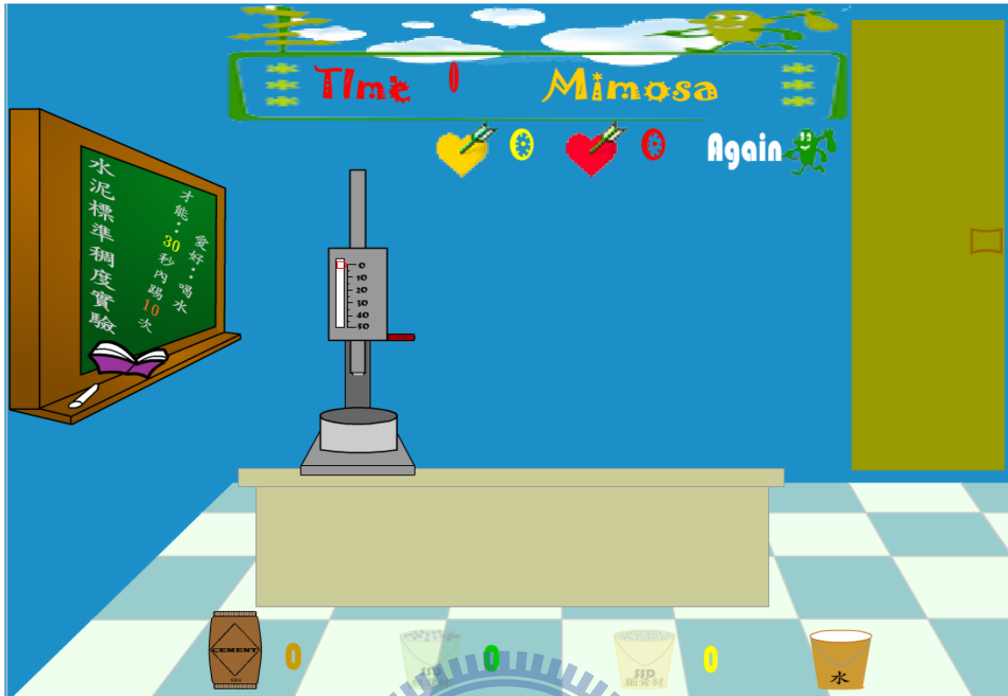
圖 3-22 水泥標準稠度實驗—碗置入維卡儀畫面
