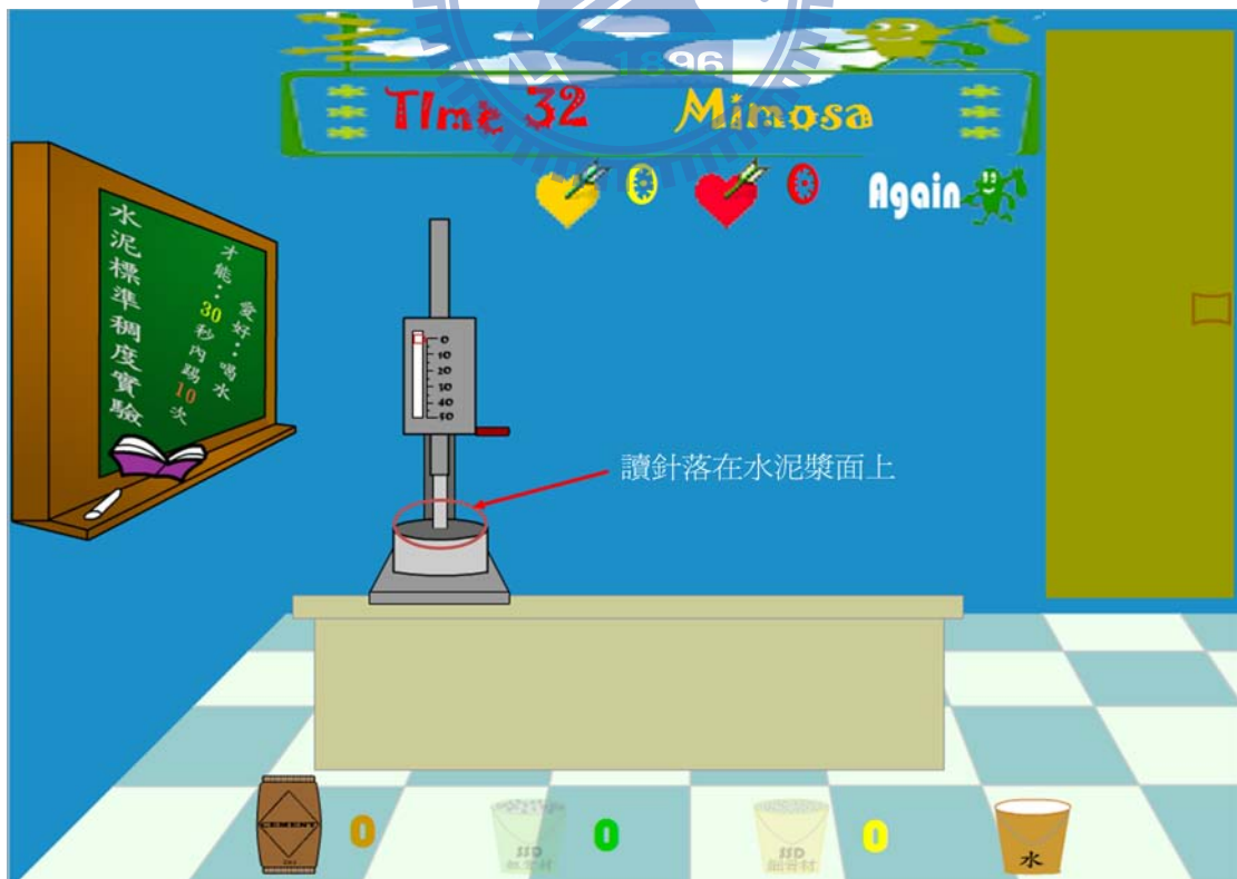
圖 3-23 水泥標準稠度實驗—維卡儀預備動作畫面
