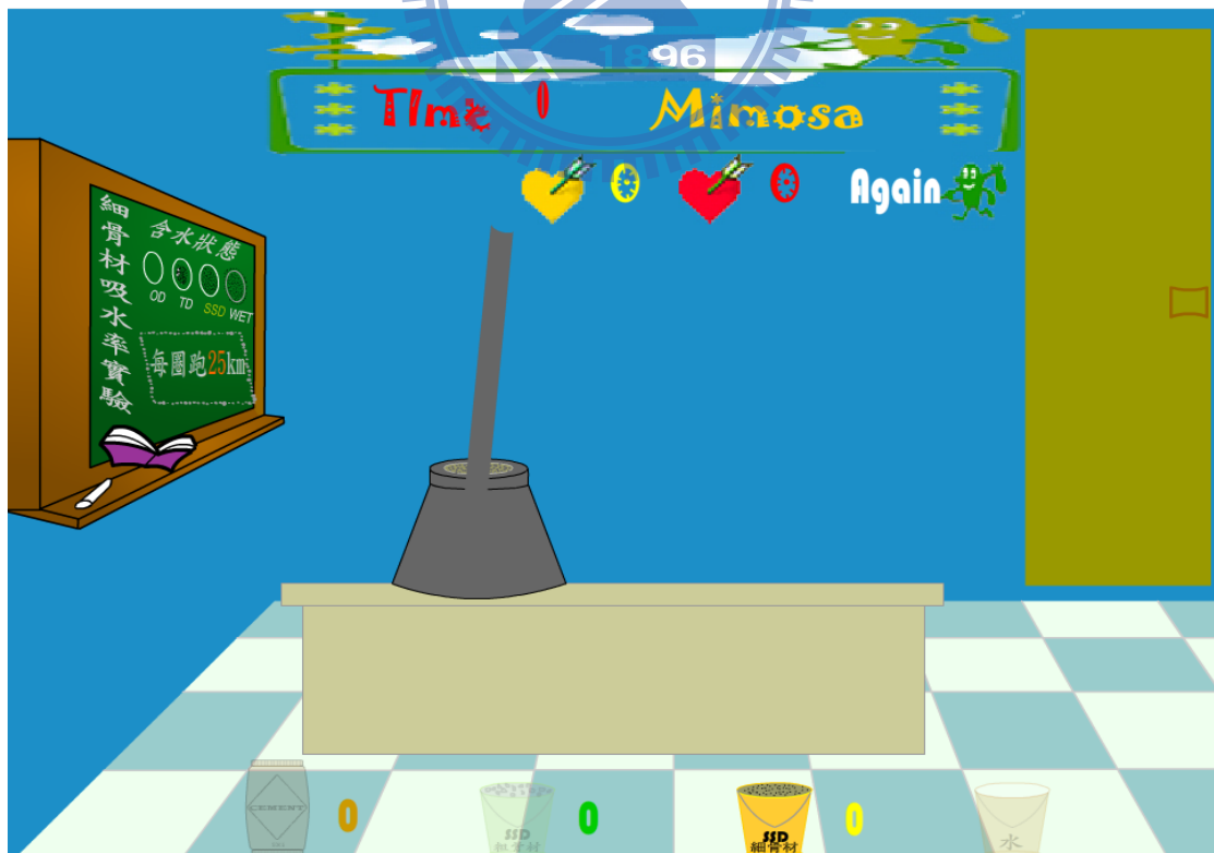
圖 3-29 細骨材吸水率實驗—填砂入圓錐模畫面(三)
