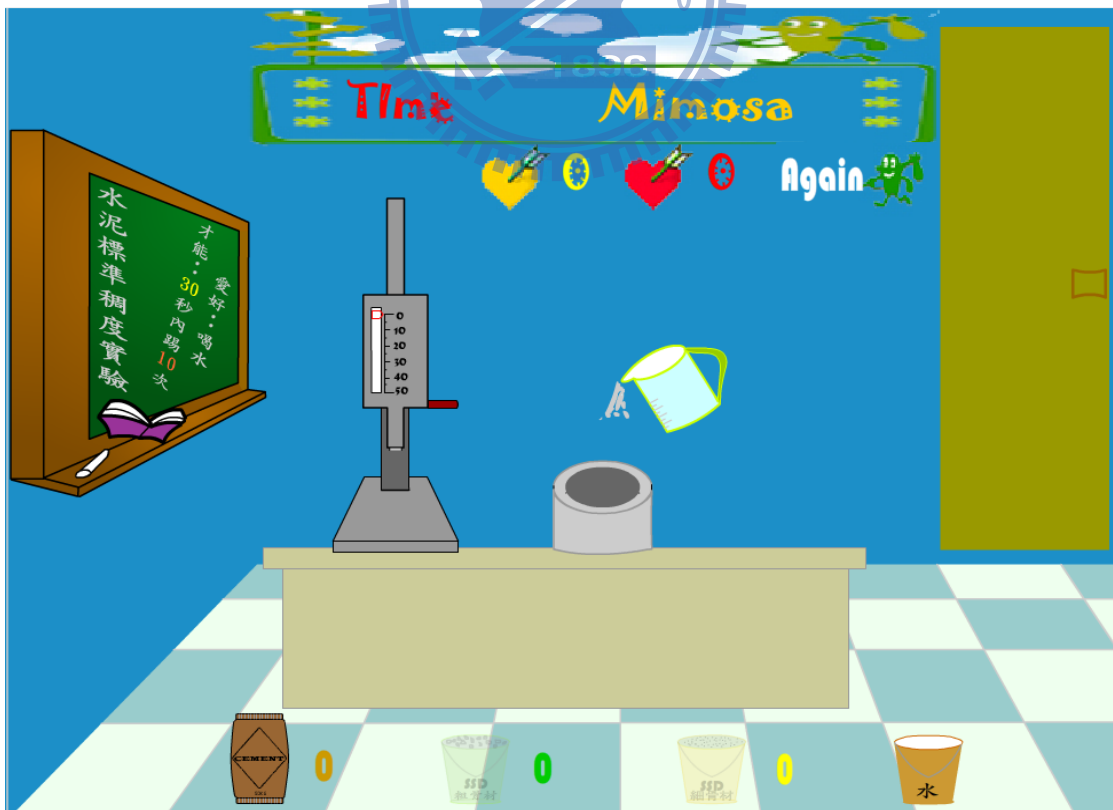
圖 3-21 水泥標準稠度實驗—加水畫面
