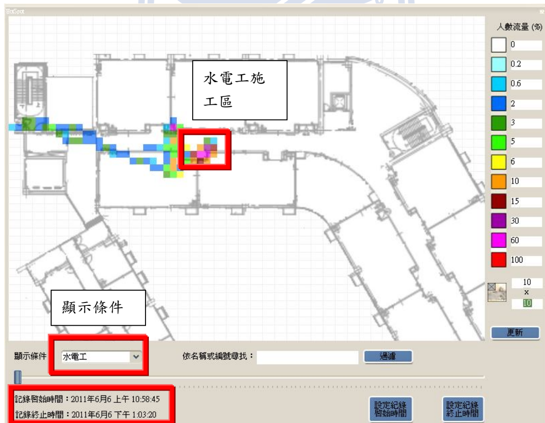
圖 5-12 施工區衝突分析-水電工施工區
