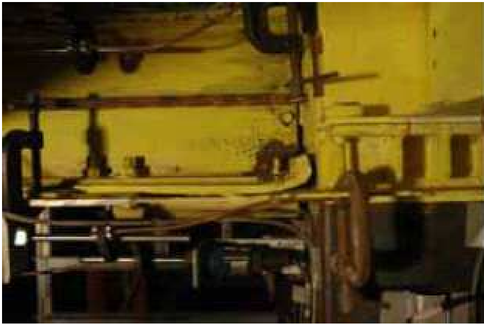
照片 4.6 局部挫屈 (第 2 階段第 8 次試驗後)
