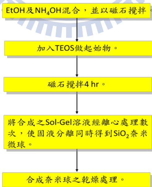
圖 3-3 合成二氧化矽奈米球之實驗流程圖。
