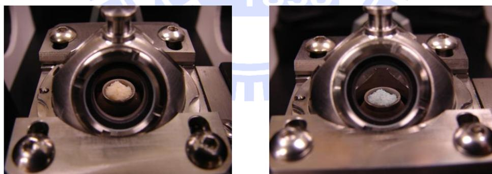
圖 4-6 (a) 以 UV-Vis 光譜儀測試粉末 Al-MCM-41/BG 吸收氨氣之結果，實驗參數為流量 400ccm，相對溼度 0%，氨氣濃度 5ppmv，測試時間為 20 分鐘，每 1 分鐘掃描一次。(b)為吸附氨氣前粉末呈現橘黃色，(c)為吸附氨氣後粉末呈現藍色。
